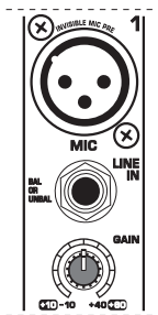
Рис. 2.1: Соединительные элементы и регулятор mic-/line-входов
